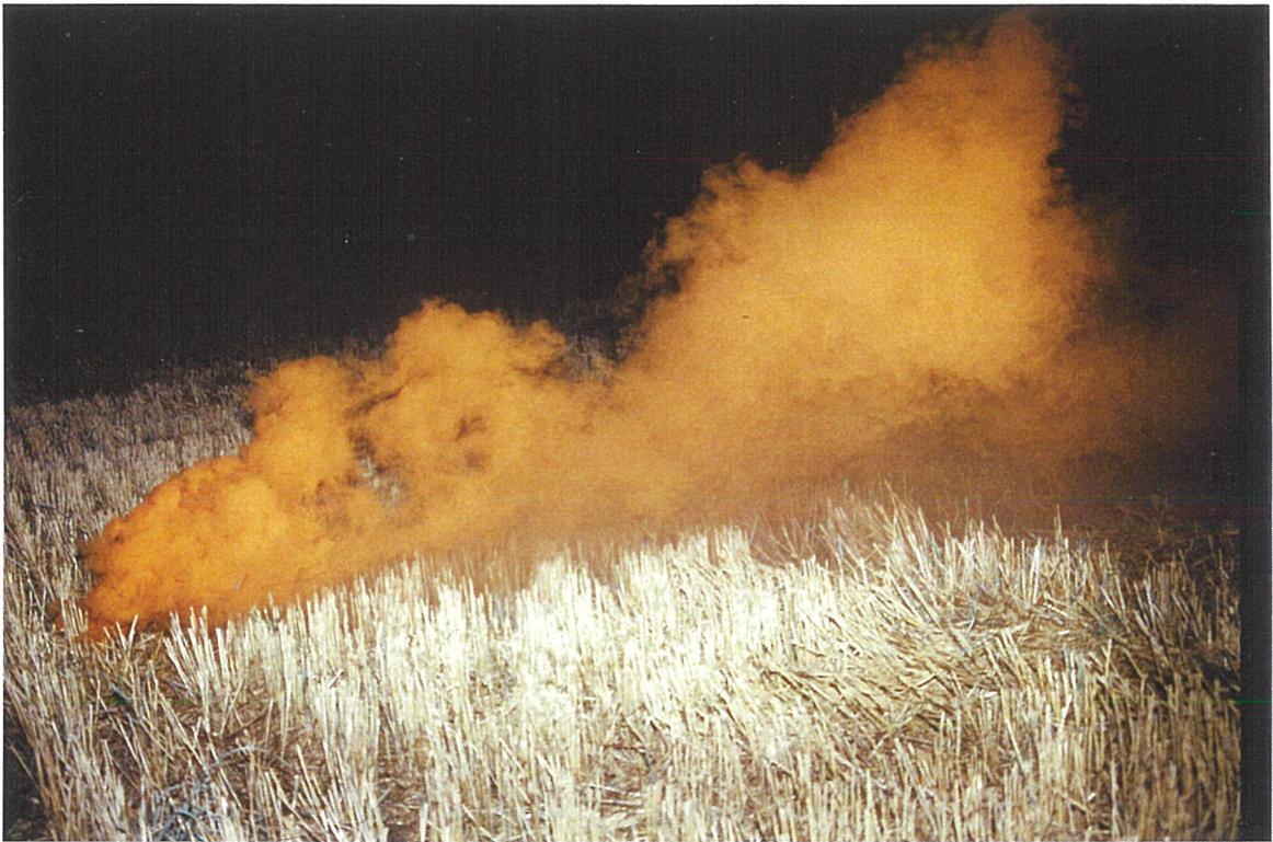
Foto 1: Rauchpatronenversuch am „Weinberg“, Meßpunkt 4. Die Luft strömt hangabwärts, Richtung Südwest. (21.09.1998, Foto: U. Döpel)
